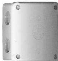
**E 143400** Feuchtraumgehäuse, Duroplast, grau wasserdicht durch Gummidichtung IP54, flammwidrig, 7 Auslässe für PG 16-Verschraubungen, 90x 90x 44mm 1,90
