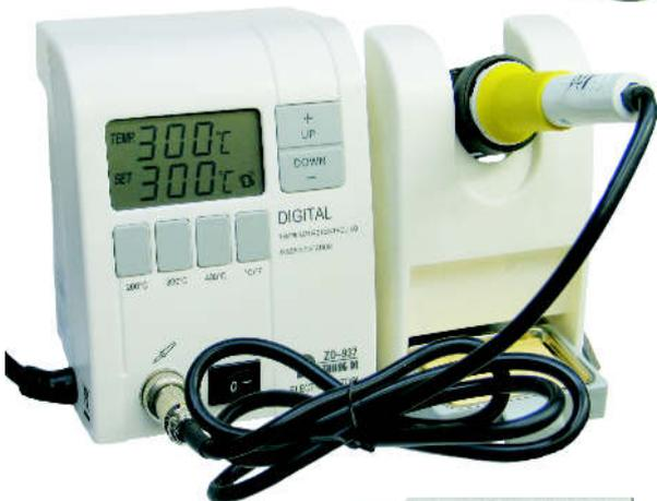
**ZD 937** Lötstation mit LCD-Anzeige
