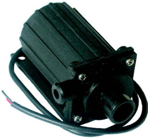
**AE 206072** Wasserpumpe aus schlagfestem Hartkunststoff, Betriebsspannung 6-12VDC 0.6A, Förderhöhe ca. 2.5m Fördermenge 6l/min, Größe Ablaufstutzen 16mm, Größe 90x 42mm 17,95
