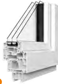
Modell: PRO Glas-Dämmwert: U_g 0,5 \text{ W/m}^2\text{K} Gesamt-Dämmwert: U_w 0,73 \text{ W/m}^2\text{K} Schallschutz: 35 dB Bautiefe: 88 mm
