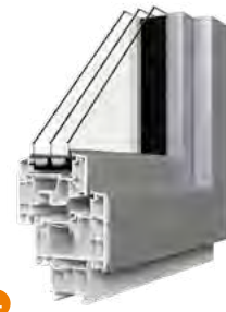
Modell: PRO Alu Glas-Dämmwert: U_g 0,5 \text{ W/m}^2\text{K} Gesamt-Dämmwert: U_w 0,73 \text{ W/m}^2\text{K} Schallschutz: 35 dB Bautiefe: 94 mm
