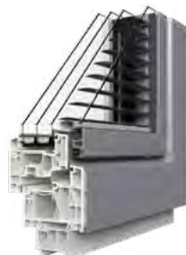
Modell: PRO Alu Verbund Glas-Dämmwert: U_g 0,5 \text{ W/m}^2\text{K} Gesamt-Dämmwert: U_w 0,76 \text{ W/m}^2\text{K} Schallschutz: 39 dB Bautiefe: 111 mm
