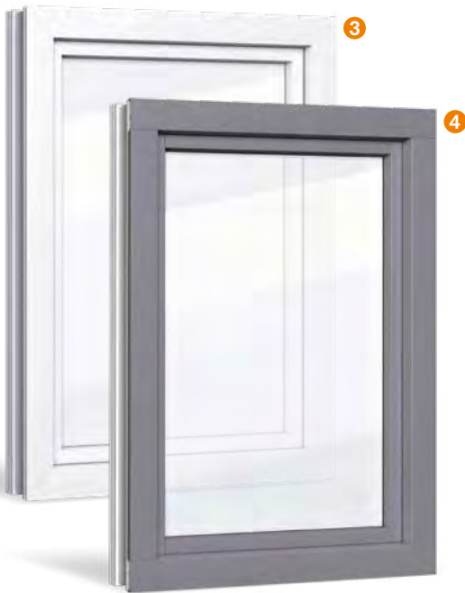
Modell: PRO Glas-Dämmwert: U_g 0,5 \text{ W/m}^2\text{K} Gesamt-Dämmwert: U_w 0,73 \text{ W/m}^2\text{K} Schallschutz: 35 dB Bautiefe: 88 mm
