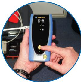
Autotest-Funktion über Remote-Gerät für Ein-Mann-Betrieb
