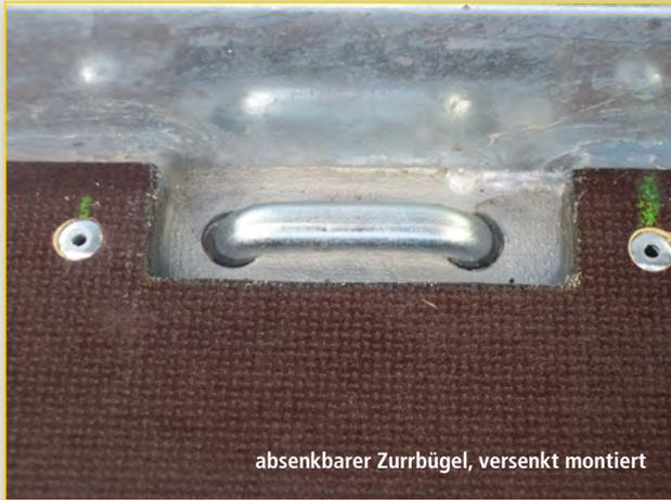
absenkbarer Zurrbügel, versenkt montiert
