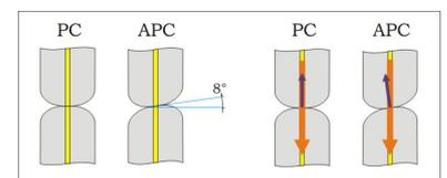
Endflächenausführung mit abgerundetem Faserende (PC) und zusätzlich gekippter Faserstirnfläche (APC) zur Erhöhung der Rückflussdämpfung (lichtführender Faserkern gelb dargestellt, Rückreflexionen durch blaue Pfeile angedeutet).
