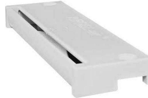
Regel-Air ist ein selbständig regelnder Fensterfalzlüfter aus Kunststoff zum paarweisen Einbau. Die automatische Volumenstrom-Begrenzung schließt die Lüfterklappen selbständig bei steigendem Winddruck. Zugscheinungen werden dadurch vermieden.
