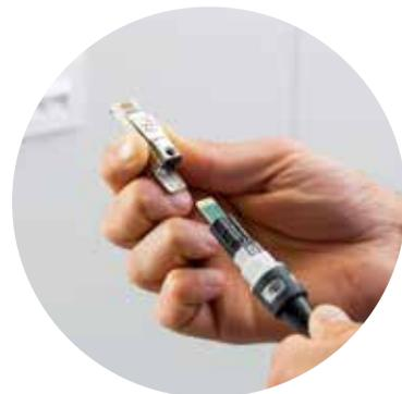
Der RJ45-Einsatz am VisiLINQ™ Permanent-Link-Modul ist vor Ort austauschbar, um die Betriebskosten zu senken. Zudem ist der Einsatz von einer unabhängigen Einrichtung für 2000 Steckzyklen verifiziert – das sind 1250 mehr als bei konventionellen Patchkabel-Steckern nach ISO/TIA-Norm.
