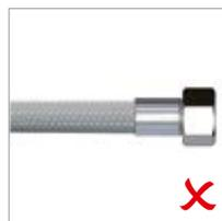
Stets überprüfen, dass die Presshülsen tatsächlich verpresst sind und keine Edelstahlfäden heraussehen. Im Zweifel den Schlauch nicht montieren.
