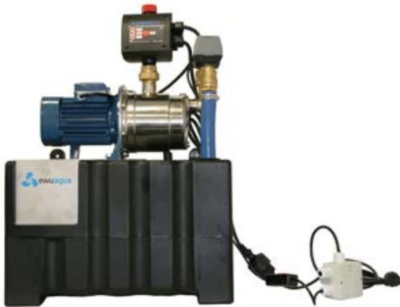
Der Regenwassermanager **iRain eco** ist eine kompakte und vollautomatische Regenwasserzentrale mit mehrstufiger Kreiselpumpe, elektronischem Druckschalter, ABS-Vorlagebehälter mit Freiem Auslauf gemäß DIN EN 1717 und einem motorgetriebenen Umschaltventil (Zonenventil). Der Regenwassermanager verfügt über keine Abdeckhaube und keine Möglichkeit zum Anschluss einer Zubringerpumpe. Er kann ausschließlich zur Wandmontage installiert werden.
