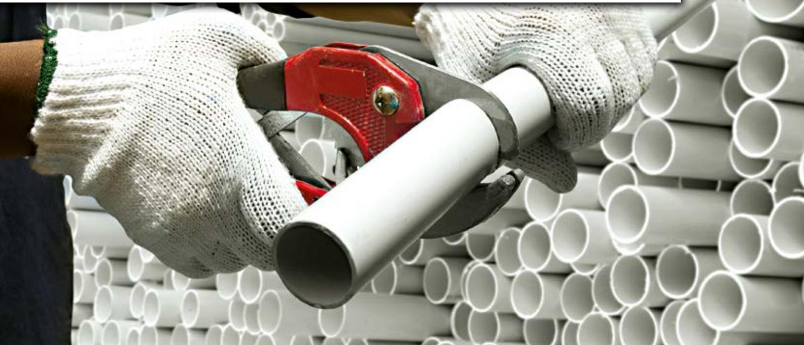
**PE-HD/Al/PE-RT**, Polymer Rohr 3 schichtig, Farbe weiß. Die Produkte sind typengeprüft und unterliegen regelmäßigen vertraglich festgelegten Überwachungsprüfungen.
