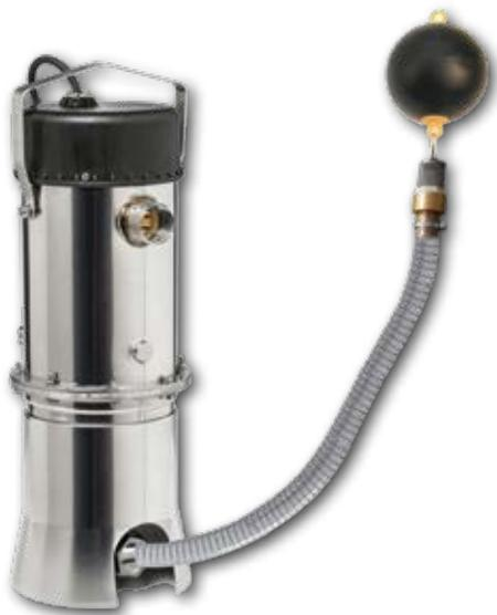
Die **iDiver Inox** ist eine **neuartige, mehrstufige Tauchpumpe mit integrierter Steuerung** für die Gartenbewässerung und Haustechnik. Aufgrund des integrierten Druckschalters gewährleistet sie ein bedarfsgerechtes Ein- und Ausschalten. Die Pumpe ist mit einem 1" Saugstutzen ausgestattet und wird mit einer 1m schwimmenden Entnahme Flex ausgeliefert sowie einem 10m Kabel.
