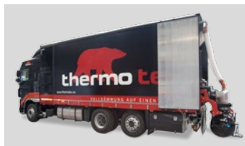
Lieferung, anmischen und pumpen erfolgt durch das thermotec® Mixmobil
