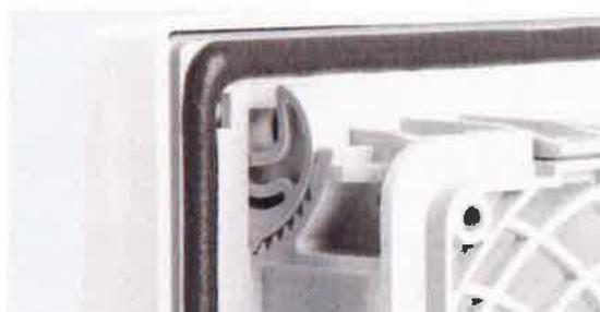
Der Filterlüfter Plus wird von außen in den Schrankausschnitt eingesetzt und werkzeuglos montiert. Durch Betätigen der 6-stufigen Drehriegel wird der Filterlüfter von innen an die Schrankwand herangezogen. Die Drehriegel rasten hörbar ein und geben dem Monteur Rückmeldung, dass das Gerät dicht und stabil sitzt. Die Drehriegelbefestigung ist für Wandstärken von 1 bis 4 mm geeignet.
