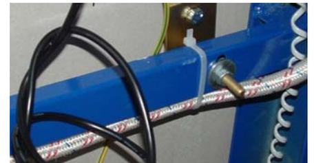
b., Nach waageschter Positionierung des Gerätes werden die Einstellungsschrauben mit der Mutter festgezogen.
