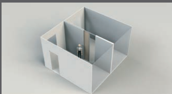
IN DIE WAND LAUFENDE SCHIEBETÜR
