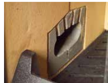
Abb.: Scheitholz Brennraum mit Pellet Tunnelstein für seitliche Pelletflamme
