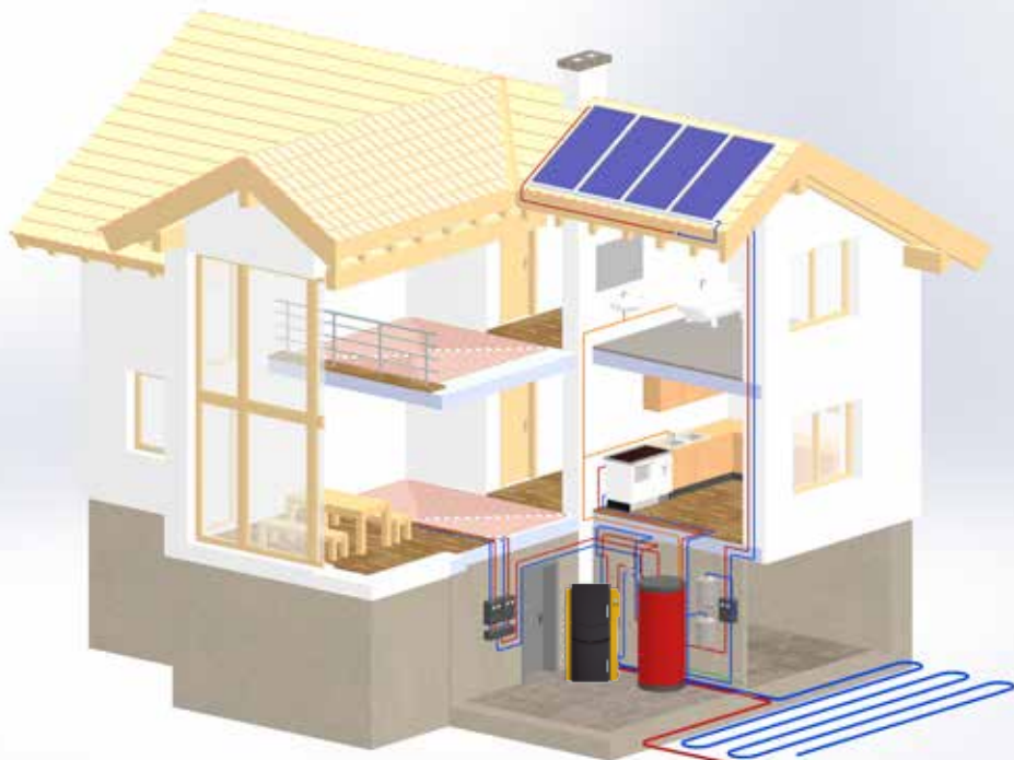
Abb.: Schnittbild Haus mit integriertem Heizungsherd
