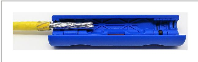
Schirmgeflecht über den Kabelmantel zurückziehen und mit Klebeband fixieren.
